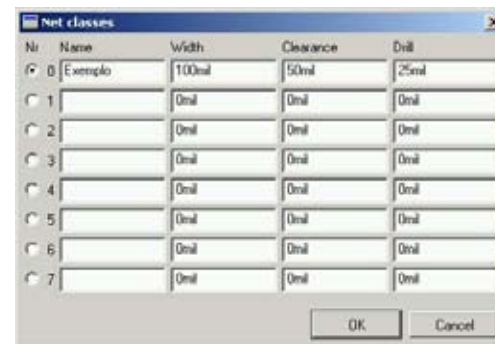
Exemplo de dimensionamento de trilhas no Eagle
