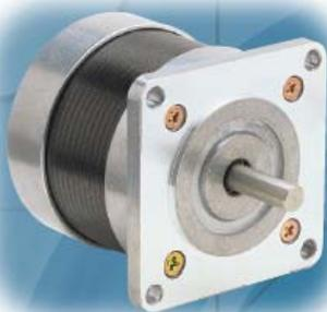
Os motores de passo se comportam diferente de outros motores DC. Primeiramente ele não pode girar livremente quando alimentado "classicamente", eles fazem como o próprio nome sugere: usam passos. Um circuito responsável de converter sinais de passo e de direção em comandos para os enrolamentos do motor é o controle lógico. Ele recebe os sinais de passos e a direção e gera os sinais para que o motor gire.
