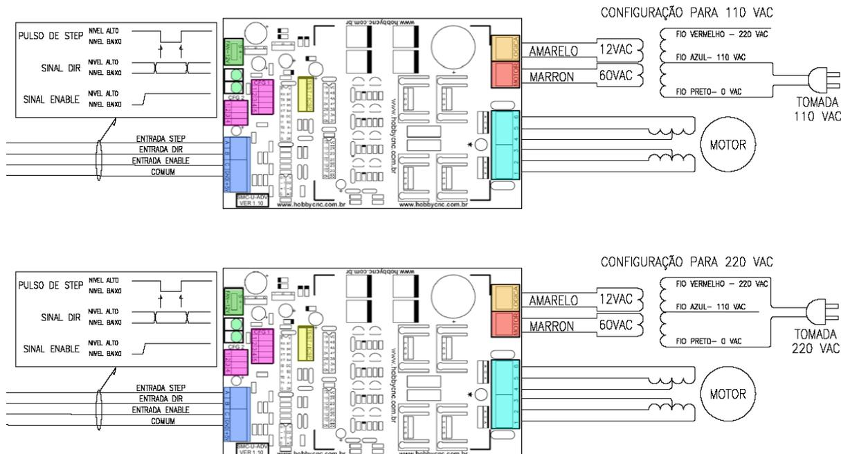
**CONTROLADORA DE MOTOR DE PASSO UNIPOLAR SMC-U-ADV - MOTOR**
