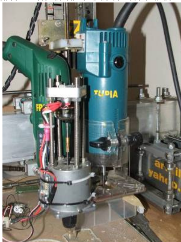
Fresa com motor de baixo ruído confeccionando PCI's.
