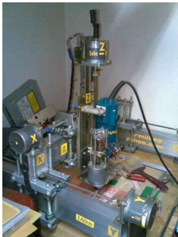
Fresa com motor de baixo ruído confeccionando PCI's.
