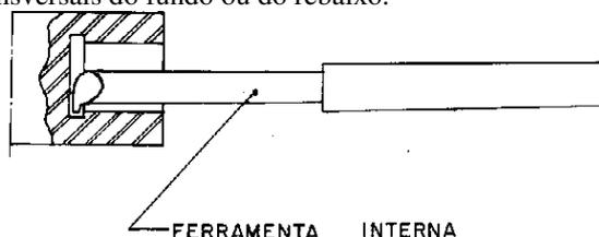
Sua aresta cortante deve fazer um ângulo de  $8^\circ$  a  $12^\circ$  com o plano transversal que por ela está sendo executada, como demonstra a próxima figura.
