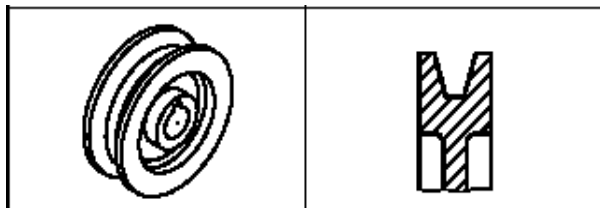
Figura 1.3.15- Polia com canal trapezoidal ou em “V”, simples.
