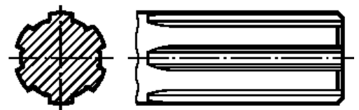
Figura 1.3.6- Eixo ranhurado
