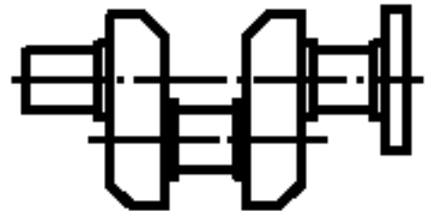
Figura 1.3.3- Eixo excêntrico tipo manivela
