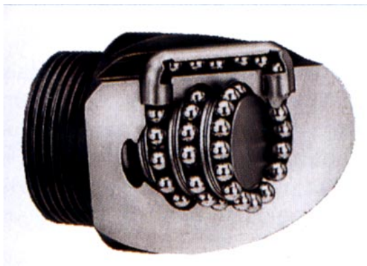
Figura 1.3.33- Ilustração do sistema de esferas recirculantes
