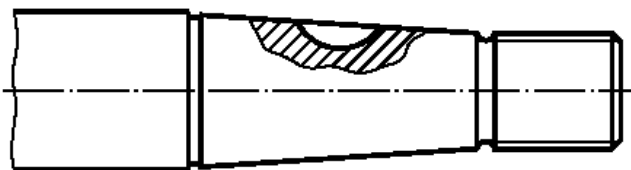
Figura 1.3.5- Eixo cônico
