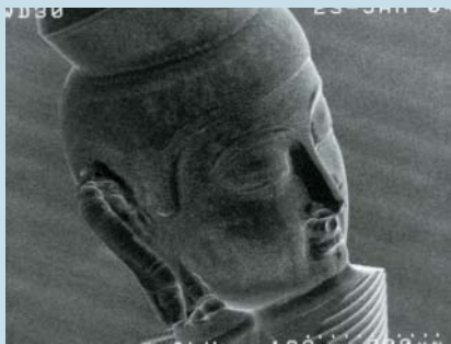
弥勒菩薩 頭部 Micro Buddha-head 直径[Diameter]:1mm、高さ[Height]:1.5mm 材質[Material]:18金[18-carat gold]
