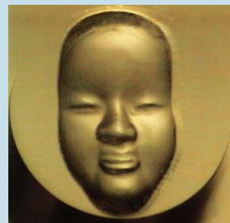
能面 Micro Noh-mask 直径[Diameter]:1mm、高さ[Height]:30 μm 材質[Material]:18金[18gold]
