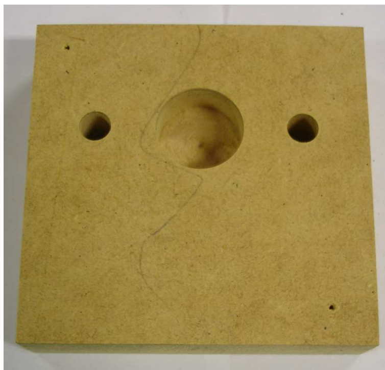
Figura 34 - Mancal de fixação lado rolamento
