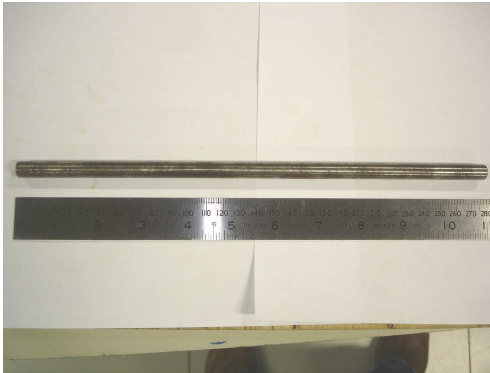
Figura 32 - Barra de aço linear do eixo Z
