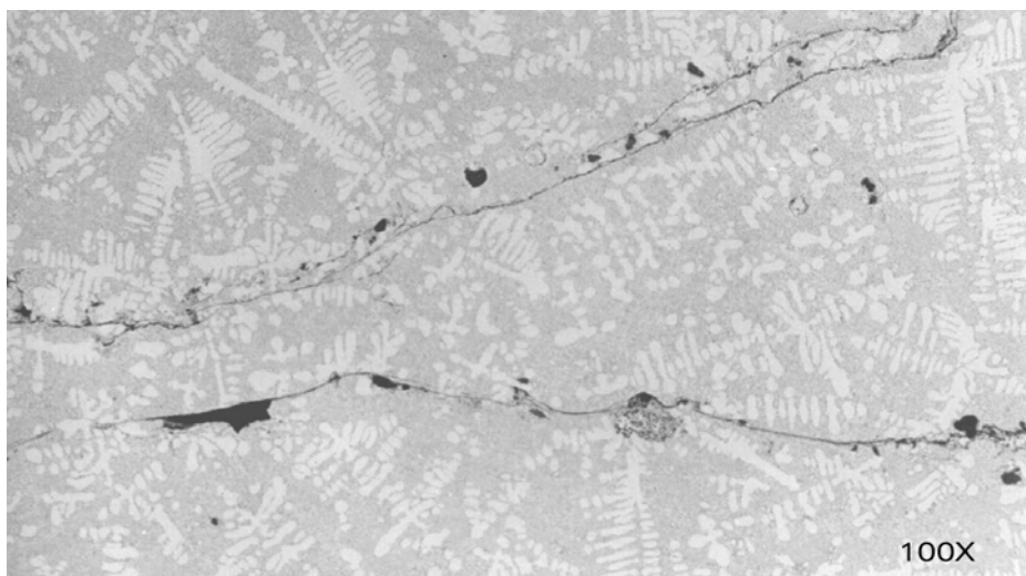
(a) – inclusões de óxidos associada à bolhas de ar em roda automotiva fabricada (processo de baixa pressão) com a liga A356.
