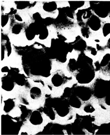
Estrutura de um filtro cerâmico do tipo espuma
