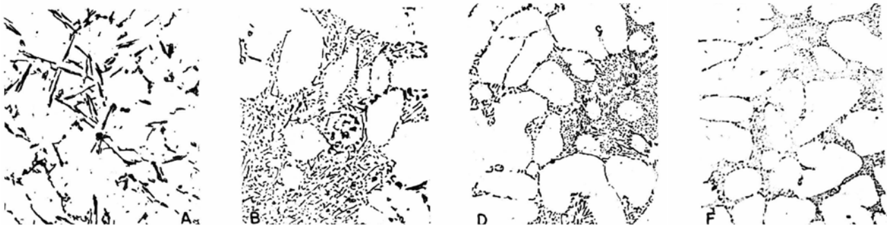
Diversos condições de modificação do eutético Al-Si, variando da condição não-modificada (A) até a plenamente modificada (F)
