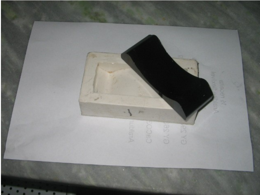
Detalhe do molde com o modelo já sacado
