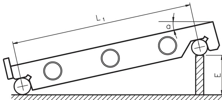
Os furos existentes no corpo da régua reduzem seu peso e possibilitam a fixação das peças que serão medidas.
