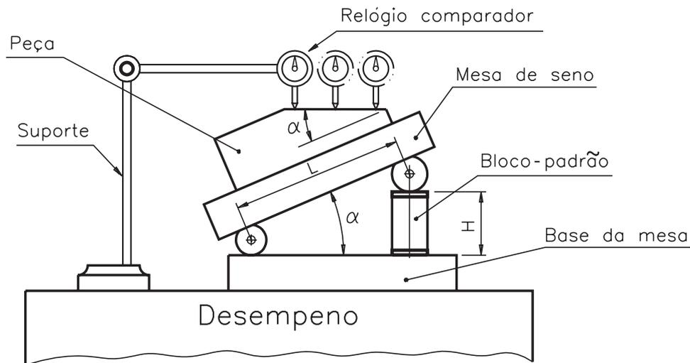
Se o relógio, ao se deslocar sobre a superfície a ser verificada, não alterar sua indicação, significa que o ângulo da peça é semelhante ao da mesa.
