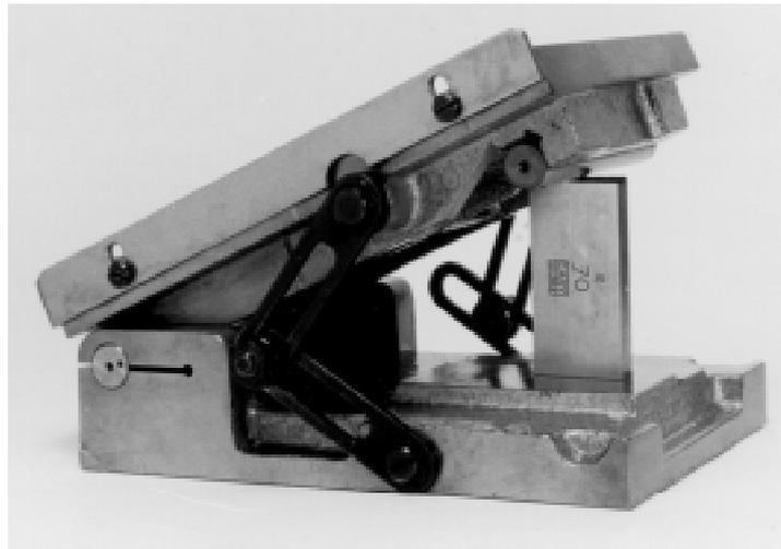
A **mesa de seno com contrapontas** permite medição de peças cilíndricas com furos de centro.
