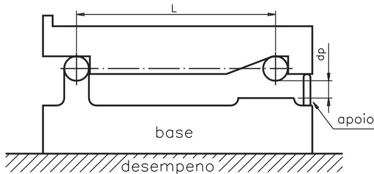
Para obter a igualdade de plano colocam-se blocos-padrão que correspondam à diferença de altura entre a base e o cilindro. Com esse recurso podemos fazer qualquer inclinação, por menor que seja, e ainda usar blocos-padrão protetores.
